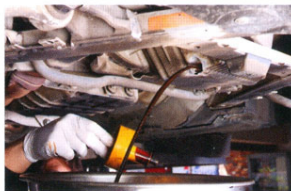
オイルをドレーンから抜き取る。排出されてくるオイルをみると真っ黒でドロドロ。
