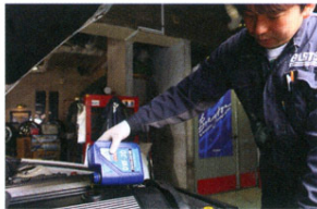
そして、LIQUI MOLYのエンジンオイルを注ぎ入れる。燃費を考えて0W-30ロングライフをチョイスした。
