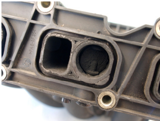
Bild 1: Ansaugbrücke Taxi nach 150.000 km
