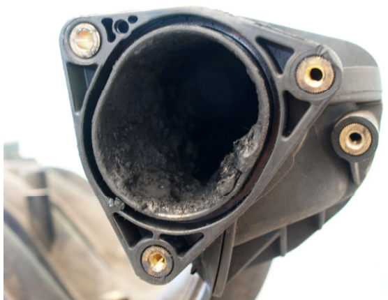
Bild 2: Ansaugbrücke Taxi nach 150.000 km
