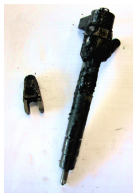
Ausgebauter Injektor mit harten Verkrustungen.
