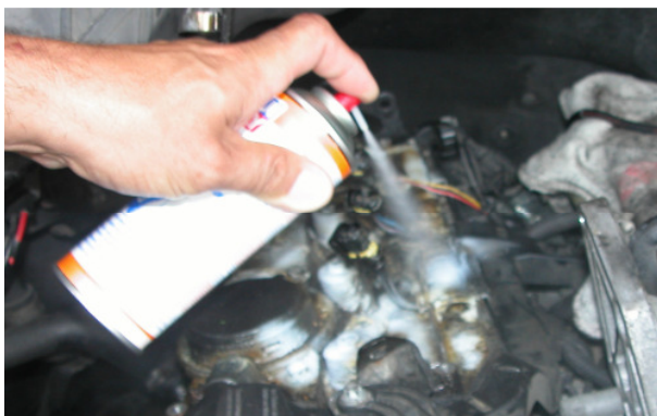
Alle Teile gründlich mit Dichtungsentferner einsprühen und einwirken lassen.
