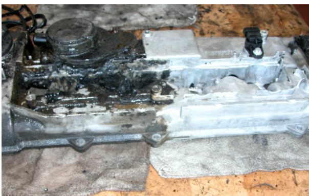
Ausgebauter Ventildeckel. Links ohne Behandlung. Rechts gereinigt mit Dichtungsentferner und Motorwäsche.
